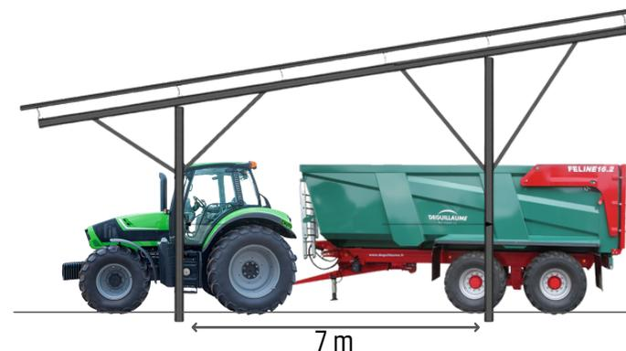
Pas de bac acier, c'est le module photovoltaïque qui compose la toiture
